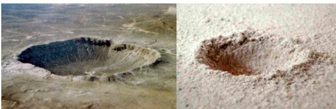
Slika 6. Lijevo: Barringerov krater u Arizoni(slika preuzeta iz [1]); Desno: jedan od laboratorijskih kratera. Vidimo da je povišeni rub, te oblik kod laboratorijskih kratera vrlo sličan onome kod pravih.
