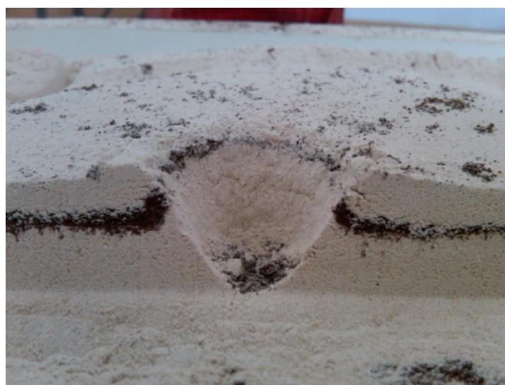
**Slika 10. Presjek kratera dobivenog zračnom puškom. Dio materijala biva potisnut direktno dolje i on završi na dnu kratera. Ostatak biva potisnut prema vani, te pri tome deformira susjedne slojeve, što se vidi iz uzdignuća u sloju kave uz stjenke kratera.**
