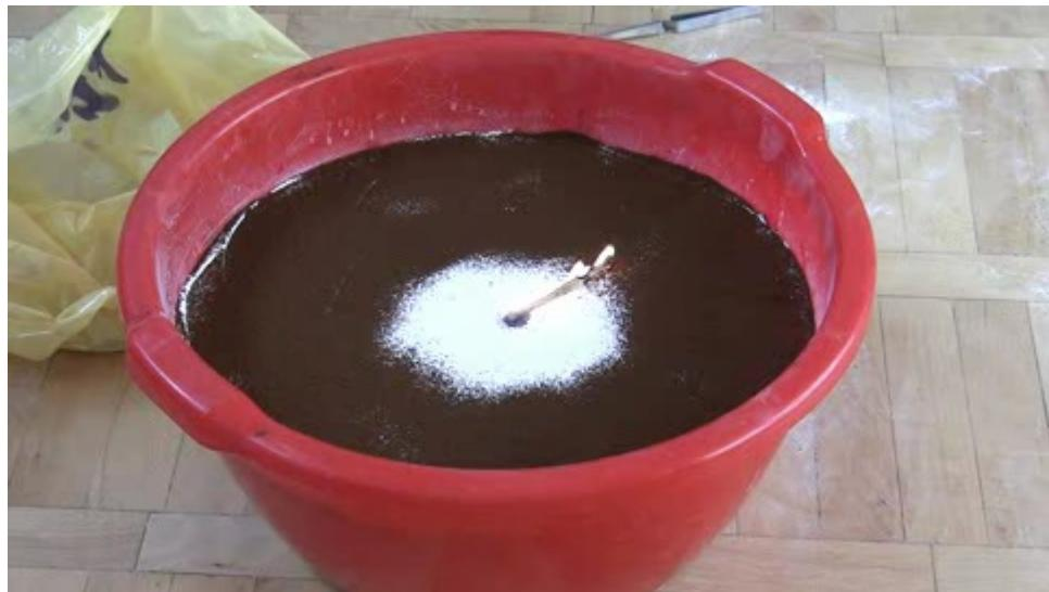
Slika 12. Detoniranje eksploziva pomoću fitilja
